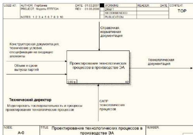
Рисунок 2 – Пример контекстной диаграммы для моделирования ТП
